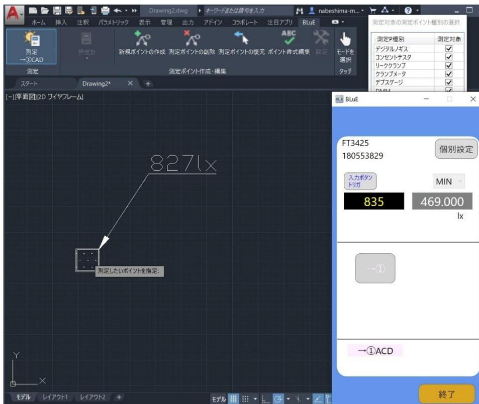
※測定画面(BLuE)で接続している測定器と AutoCAD 上の測定ポイント種別が、同じでないと測定ポイントに測定値を反映することができません。
