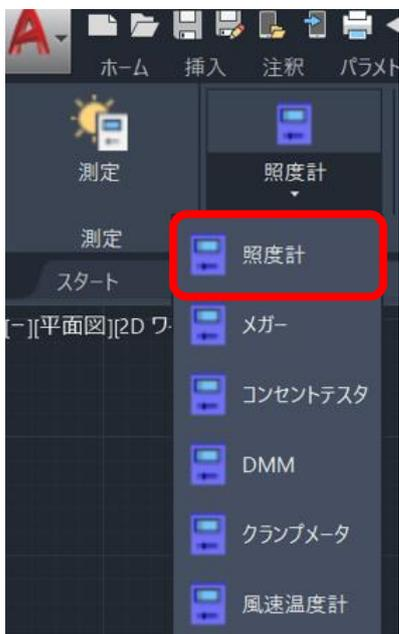
(2) リボンメニューの「新規ポイントの作成」を押下し、図面上の任意の箇所をピックすると測定ポイントが作成されます。
