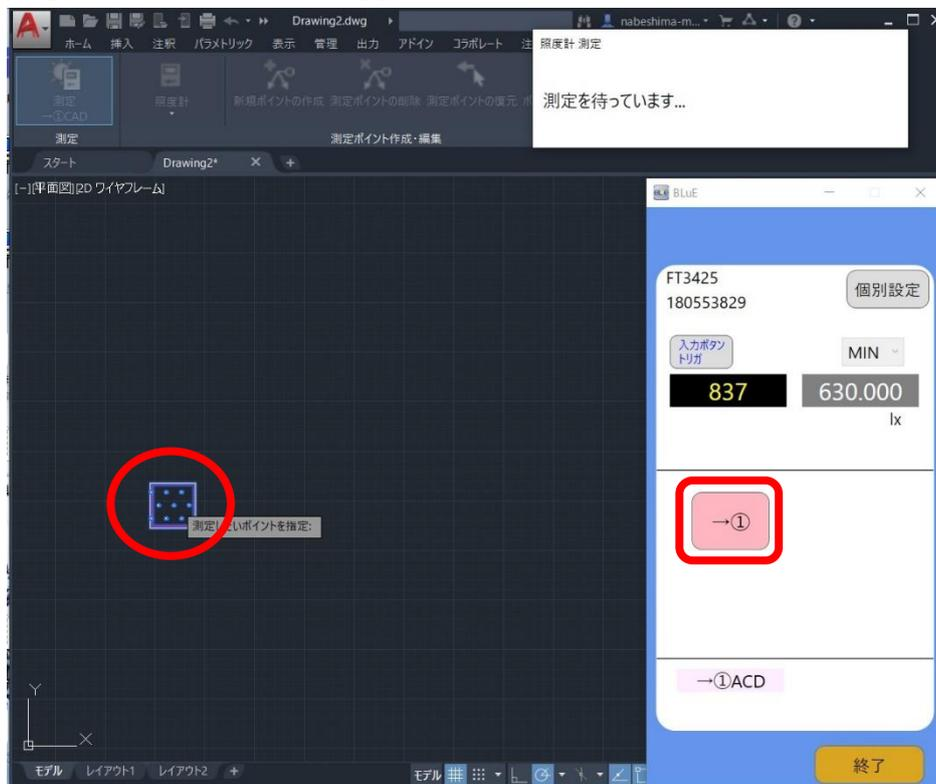
(4) 測定画面の測定ボタン (→①) を押下すると、ピックアップした測定ポイントに対して測定値が反映されます。
